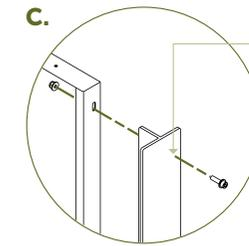
PERCER DES TROUS POUR LES PIÈCES D'ANGLE
